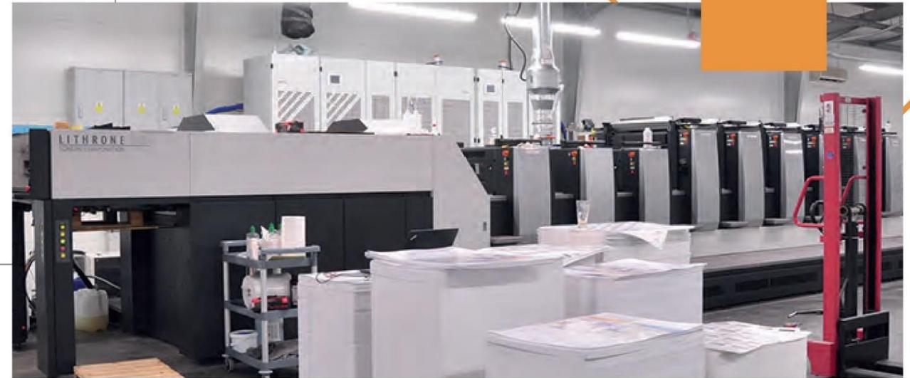
Wir bieten hochwertigen Offset- und UV-Offsetdruck auf 6- und 5-Farben-Maschinen mit Lackierwerk an. Komori Lithrone GL-629: 6-Farben-Druck mit zwei UV- Lackierwerken oder Dispersion sowie Trocknung, die Maschine ist mit einem automatischen System zur Korrektur von Färbung und Tonwertzunahme ausgestattet..
