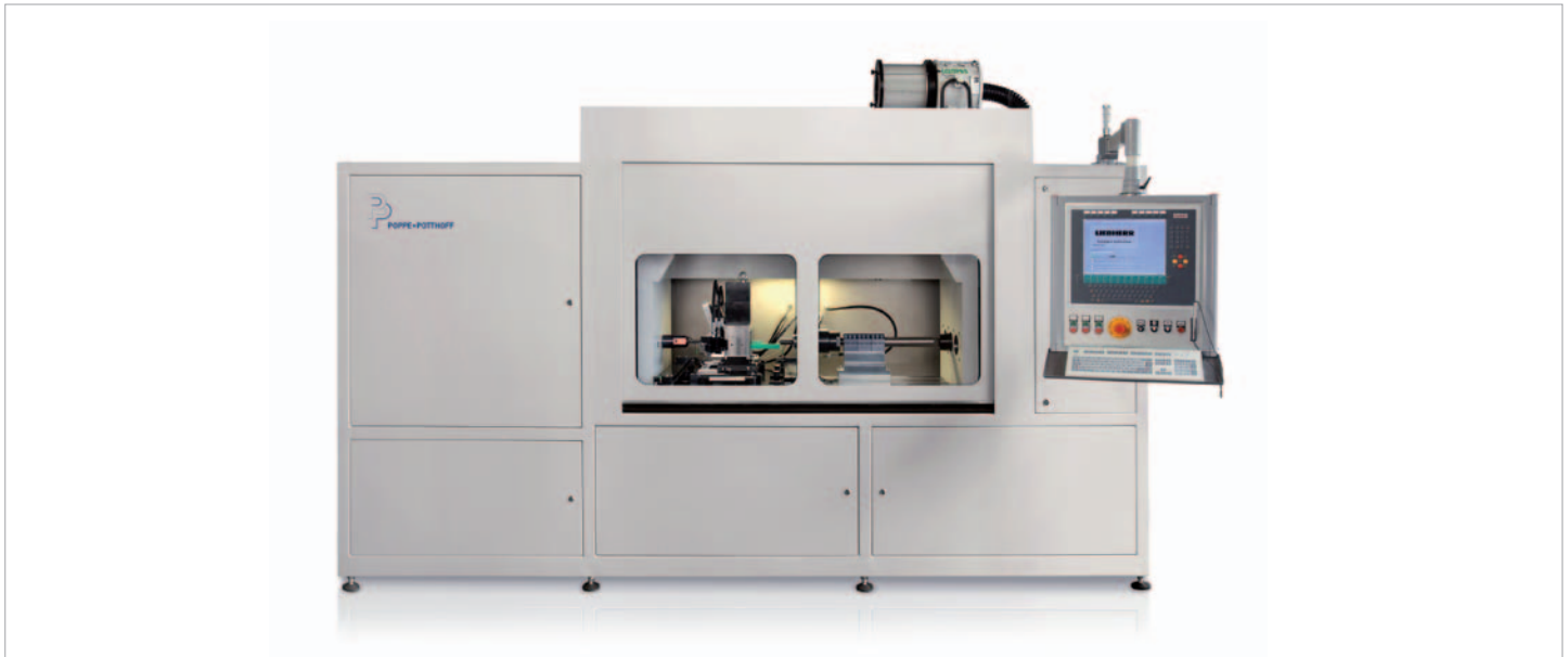
Autofrettage zur Erhöhung der Dauerfestigkeit im Prototypen-Bau.
