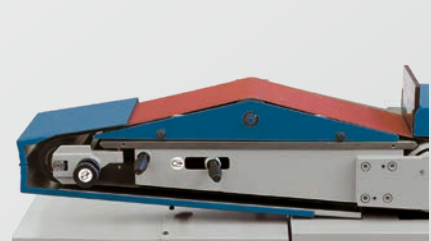
B 200/150 S mit Zubehör: Umlenkrolle B 200/150 S with accessories: Guide roller
