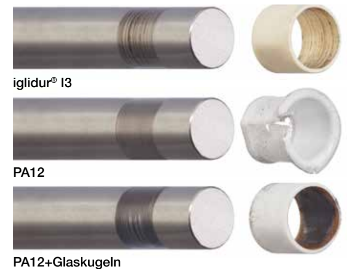
Reibwert rotierend v = 0,1 m/s; p = 1 MPa; Welle: Cf53
