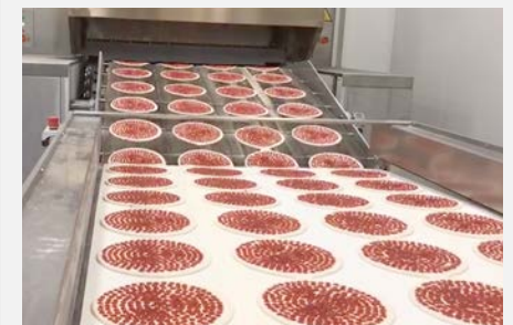
Dosificadora DA para salsa de tomate prerarada para acoplarse a una línea continua de producción de pizza
