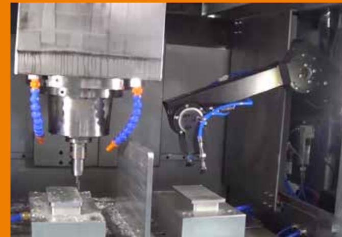
roboLink® D – Saugarm in einer Werkzeugmaschine (igus®)
