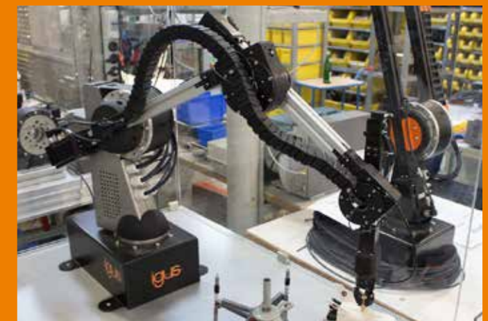
Messemaschine RL-DQ-RBT-5532S-AC mit 5 DOF und 3-Finger Greifer (igus®)
