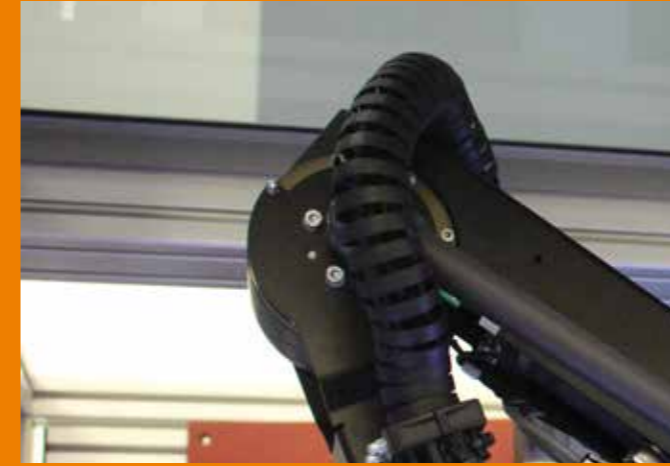
roboLink® D zur Überprüfung von Leiterplatten (4Stars Engineering Systems GmbH)
