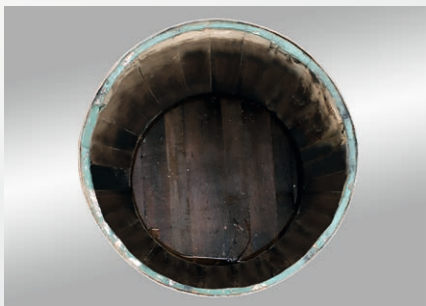
Cask before skiving/grinding. Fass vor dem Raspeln.
