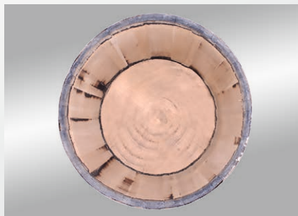
Cask after skiving/grinding. Fass nach dem Raspeln.
