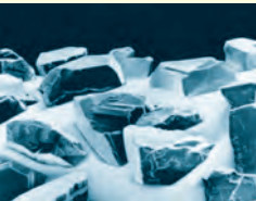
Die Einbindung der Körnung erfolgt durch eine elektrogalvanisch aufgetragene Schicht, die jedem Korn genügend Aktionsraum bietet.
