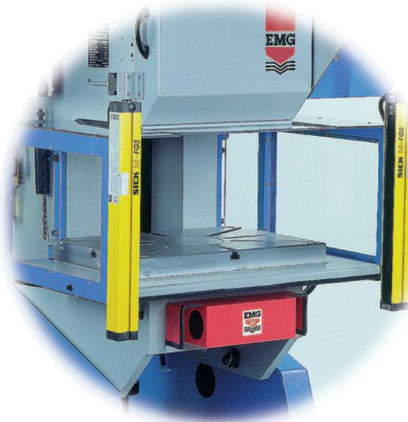
Les barrières immatérielles permettent la protection frontale de la zone dangereuse et commandent le démarrage du cycle après un ou deux passages dans le faisceau. Supprimant l'utilisation de la commande bimanuelle, cet équipement assure une sécurité maximale tout en améliorant la productivité de la presse.
