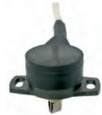
Der Weggeber GEMÜ 4231 ist für den Anbau an Ventile mit Schwenkantrieben mit 90° Drehwinkel vorgesehen und dient der Ermittlung der Ventilstellung. Er wird als Weggeber der intelligenten Stellungsregler GEMÜ 1434  $\mu$ Pos, GEMÜ 1435 ePos und GEMÜ 1436 cPos verwendet, welche wahlweise mittels der offenen Aderenden oder eines M12-Kabelsteckers angeschlossen werden können (je nach Ausführung bzw. Auswahl des Reglers).
