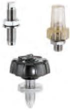
Durch Öffnungshubbegrenzungen werden pneumatische Linearantriebe von GEMÜ Absperrklappen, Kugelhähnen, Membranventilen und Sitzventilen nicht vollständig geöffnet. Somit wird der maximale Durchfluss eines Ventils begrenzt. Wahlweise ist die Öffnungshubbegrenzung mit Handrad, Schauglas, Stellungsanzeige oder Handnotbetätigung erhältlich.
