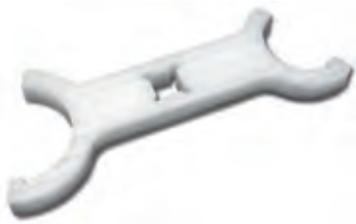
Das Service-Werkzeug GEMÜ CFSTF dient der Montage von Flare-Überwurfmuttern GEMÜ CF aus PFA, PVDF und kohlefaserverstärktem PFA. In Kombination mit einem Drehmomentschlüssel lässt sich ein genau definiertes Drehmoment erzielen.
