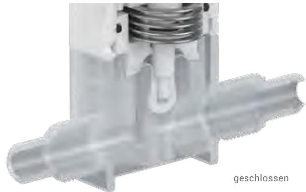
Membransitzventile basieren auf einem innovativen Dichtsystem, das GEMÜ entwickelt hat um die Vorteile von Membranventilen mit denen eines Sitzventils zu kombinieren. Durch den grundsätzlichen Aufbau wie bei einem Sitzventil können schnelle Schaltwechsel und hohe Schaltfrequenzen erreicht werden. Durch eine konusförmige Membrane als Dichtelement ist der Antrieb, wie bei Membranventilen, hermetisch vom Medium getrennt.
