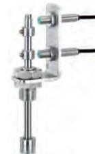
Bei GEMÜ 1216 handelt es sich um eine offene Initiatoraufnahme für zwei Näherungsinitiatoren M8 x 1 für pneumatisch betätigte Linearantriebe. Sie verfügt über zwei einstellbare Schaltnocken und kann wahlweise mit oder ohne Hubbegrenzung bestellt werden. Der Schaltabstand ist abhängig von den verwendeten Initiatoren. Die Basisausführung enthält keine Näherungsinitiatoren.
