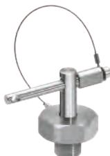
Durch die Offenhaltevorrichtung GEMÜ 1107 bleiben pneumatisch betätigte Membranventile in der Offen-Position, auch wenn sie nicht mit Steuermedium beaufschlagt werden. Optional kann sie durch ein Bügelschloss gesichert werden. Die Offenhaltevorrichtung GEMÜ 1107 kann bspw. zum Autoklavieren verwendet werden.
