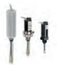
Der Weggeber GEMÜ 4232 ist für den Anbau an Ventile mit Linearantrieben vorgesehen und dient der Ermittlung der Ventilstellung. Er wird als Weggeber der intelligenten Stellungsregler GEMÜ 1434  $\mu$ Pos, GEMÜ 1435 ePos und GEMÜ 1436 cPos verwendet, welche wahlweise mittels der offenen Aderenden oder eines M12-Kabelsteckers angeschlossen werden können (je nach Ausführung bzw. Auswahl des Reglers).
