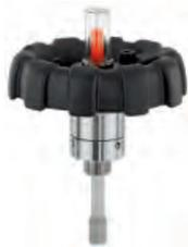
GEMÜ 1002 ist eine Handnotbetätigung für pneumatische Linearantriebe bei Membran-, Sitz- und Regelventilen. Eine optische Stellungsanzeige ist serienmäßig integriert. Die Handnotbetätigung ist nicht als Schließhubbegrenzung einsetzbar.
