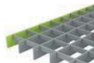
ÉTAPE 3 Mise en place des bordures
