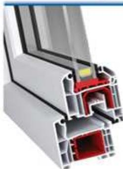
L'Idéal 4000 est un système d'usage universel qui peut être employé dans tout les types de construction neuve, mais aussi en rénovation. La structure à 5 chambres et l'épaisseur de 70 mm assurent une bonne isolation thermique et acoustique. Son coefficient de transmission thermique  $U_f = 1,3 \text{ W} / (\text{m}^2 \text{ K}^*)$ . La finesse des profilés et leurs formes classiques garantissent une élégance intemporelle.
