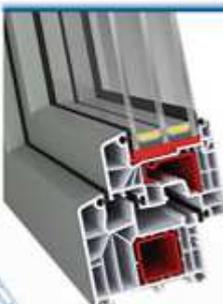
Le système Ideal 8000 a été développé pour améliorer la performance thermique et acoustique des fenêtres. Cela a été possible grâce à l'augmentation de l'épaisseur des profilés - 85mm, 6 chambres, 3 joints d'étanchéité. Son coefficient de transmission thermique  $U_f = 1,0 \text{ W} / (\text{m}^2 \text{ K}^*)$  est adapté aux bâtiments BBC et passifs.
