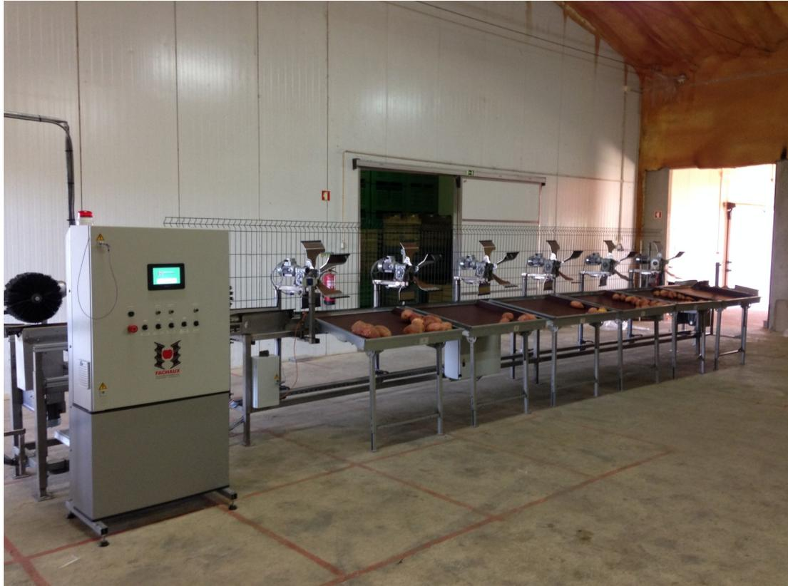
Calibreuse **électronique au poids**, gérée par **automate industriel de pesée a écran tactile**.
