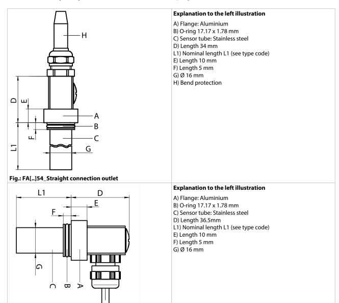
Fig.: FA[..]54\_Bottom connection outlet
