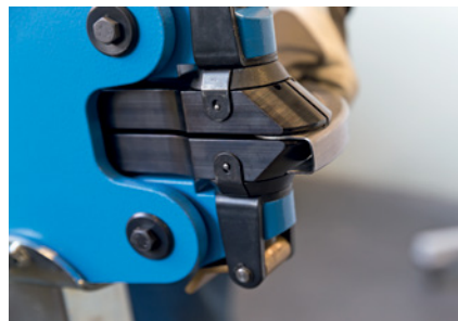
Stauen von U-Profilen mit geringer Steghöhe / Shrinking low webbed U-profiles
