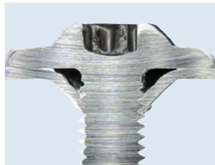
Zweistufiges Verfahren: Schliffbild der geschraubten Presswerkprüfung / Two-step technique: microsection of screw in extrusion-embossed hole
