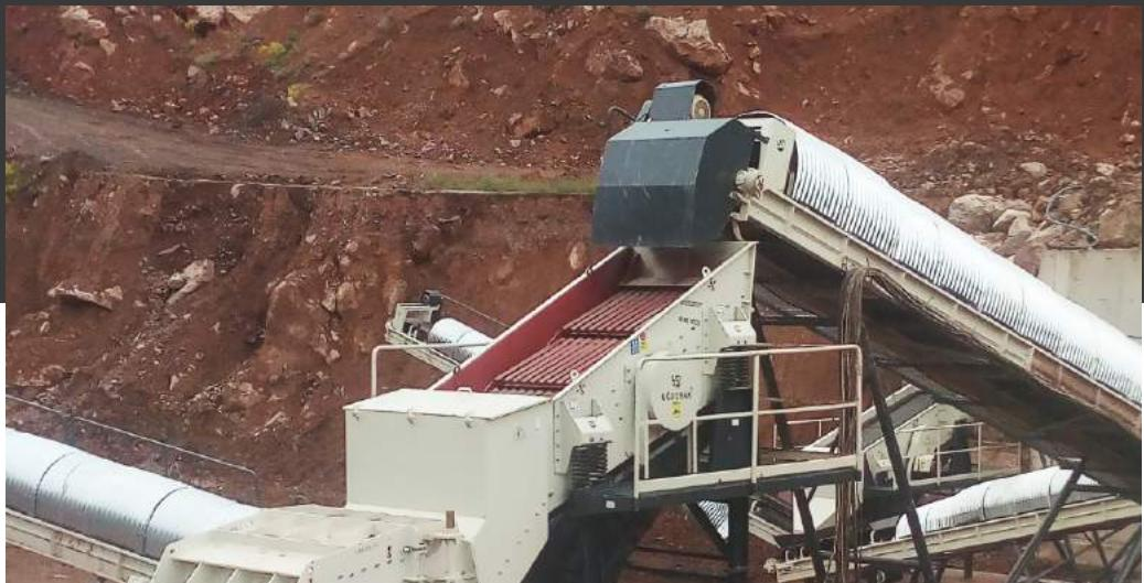
UĞURMAK UMIE serisi Izgaralı Elekler, genellikle kırma eleme prosesinin iki farklı aşamasında kullanılır.
