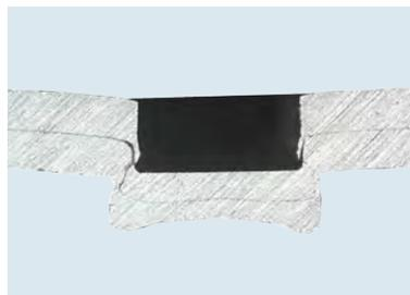
Schliffbild einer zweilagigen Clinchverbindung S-DF / Cross-section of a two-layer connection S-DF
